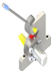
شکل-۲. فرآیند و عملکرد برش پیچ داخل دستگاه
