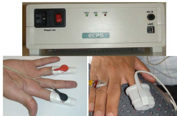
شکل ۱. دستگاه CPS و نحوه‌ی قرارگیری سنسورها بر روی دست
