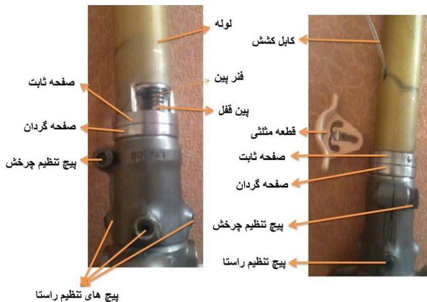
شکل-۲. جزئیات عملکرد قطعه چرخاننده مچ پای پروتزی
